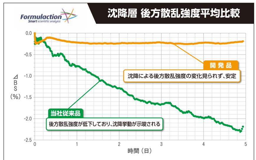
測定: 液中分散安定性評価装置 Turbiscan
