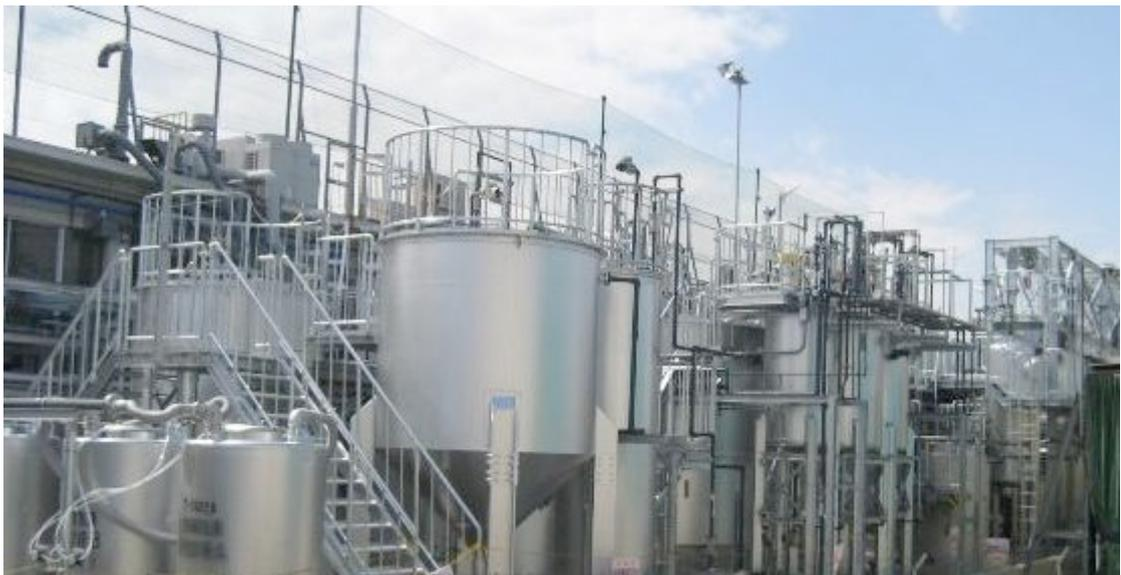
当事業所から汚染地下水が当社敷地外に広がらないように、敷地境界に近い場所から、汚染地下水を汲み上げ、河川放流できる水質まで浄化し、下水道に排水します。また、汚染源付近から汲み上げた地下水も河川放流できる水質まで浄化し、下水道に排水します。
